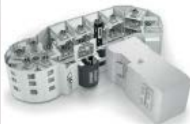
PHS Allround Magasin linéaire de palettes Extensible de 1 à 4 machines
